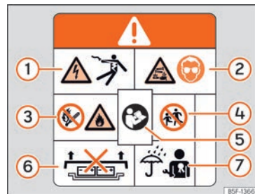
Rys. 209 Napis ostrzegawczy akumulatora wysokonapięciowego.
