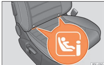
Rys. 33 Przednie siedzenie pasażera: uchwyty mocujące ISOFIX / iSize.
