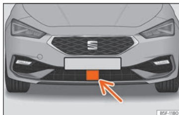
Rys. 167 Na przednim zderzaku: czujniki radarowe.
