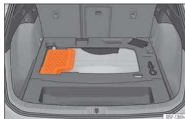
Rys. 231 Umieszczenie akumulatora w bagażniku.
