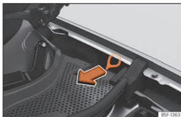
Rys. 213 Pomiedzy panelem lewego skrzydła a zawiasem maski silnika: Ściągacz ręcznego mechanizmu zwalnającego złącze ładowania.
