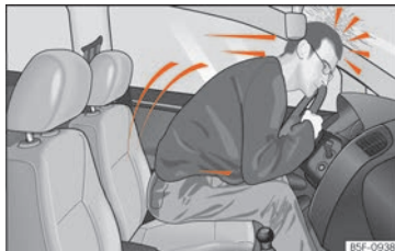
Rys. 12 Kierowca nieposiadający zapiętych pasów bezpieczeństwa zostaje wyrzucony gwałtownie do przodu.
