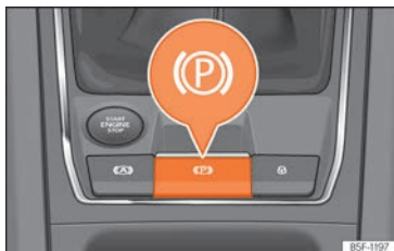
Rys. 195 W dolnej części konsoli środkowej: elektroniczny hamulec postojowy
