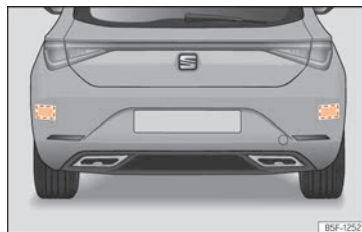
Rys. 170 Widok pojazdu z tyłu: strefy działania czujników radarowych.
