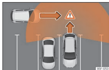
Rys. 192 Diagram przedstawiający działanie systemu monitorowania ruchu poprzecznego przy cofaniu: obszar monitorowany wokół pojazdu wyjeżdżającego z miejsca parkingowego.
