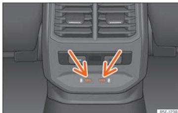
Rys. 160 Z tyłu konsoli środkowej: gniazda USB z funkcją gniazda zasilania.
