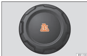
Rys. 228 Komora silnika: korek zbiornika wyrównawczego płynu chłodzącego.
