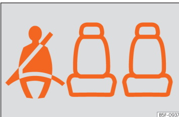
Rys. 10 Tablica przyrządów: informacja o tym, czy lewe tylne siedzenie jest zajęte i czy pasażer na nim ma zapięte pasy.
