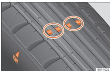
Rys. 235 Profil opony: wskaźniki zużycia bieżnika.
