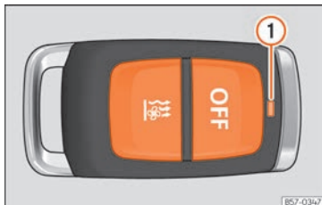
Rys. 151 Ogrzewanie pomocnicze: pilot radiowy zdalnego sterowania.
