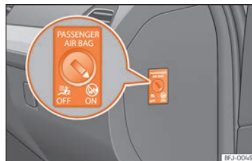
Rys. 20 Przetącznik czołowej poduszki powietrznej pasażera.
