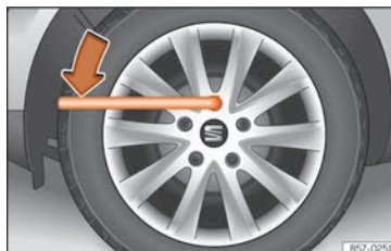
Rys. 43 Zmiana koła: poluzować śruby koła.
