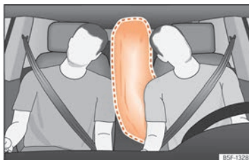
Rys. 25 Całkowicie napęczniona środkowa poduszka powietrzna (strefa zadziaania).
