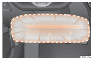
Rys. 23 Po stronie kierowcy: promień działania poduszki chroniącej kolana.
