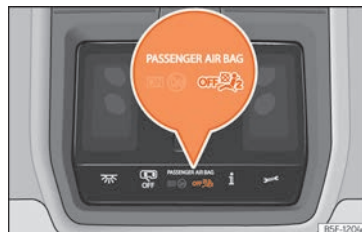
Rys. 21 Na konsoli w podsufitce: lampka kontrolna wyłączenia przedniej poduszki powietrznej pasażera.
