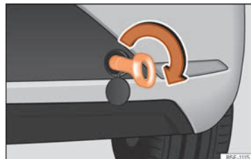
Rys. 103 Prawa strona tylnego zderzaka: wkręcony pierścień holowniczy.
