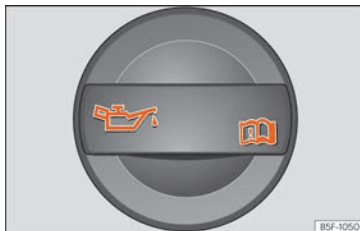
Rys. 311 W komorze silnika: Korek wlewu oleju silnikowego.
