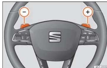
Rys. 260 Kierownica: pokrętki automatycznej zmiany biegów
