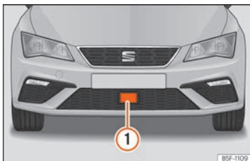
Rys. 266 Na przednim zderzaku: czujnik radarowy.
