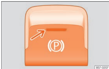
Rys. 255 W dolnej części konsoli środkowej: przycisk elektrycznego hamulca postojowego.
