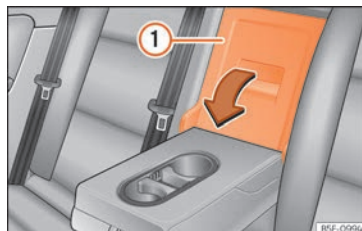
Rys. 183 W oparciu tylnego siedzenia: przejście z kabiny do bagażnika.
