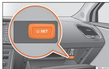
Rys. 316 Schowek podręczny: przetącnik monitorowania opon.
