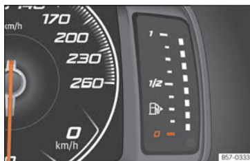
Rys. 132 Cyfrowa tablica przyrządów: wskaźnik poziomu paliwa.
