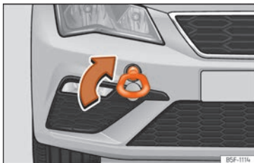
Rys. 80 Prawa strona przedniego zderzaka: wkręcony pierścień holowniczy.
