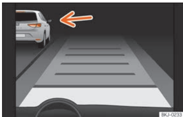
Rys. 274 Na wyświetlaczu tablicy rozdzielczej: ACC aktywny, wykryto pojazd na lewym pasie
