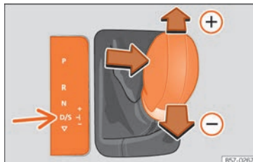
Rys. 259 Konsola środkowa: zmiana biegów w trybie tiptronic
