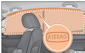
Rys. 34 Umieszczenie poduszek powietrznych chroniących głowę.
