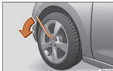
Rys. 77 Koło: poluzować śruby koła.
