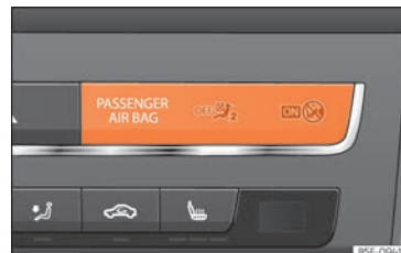
Rys. 29 Deska rozdzielcza: lampka kontrolna wyłączenia czołowej poduszki pasażera w konsoli środkowej.
