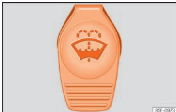
Rys. 66 W komorze silnika: korek zbiornika płynu do spryskiwaczy.
