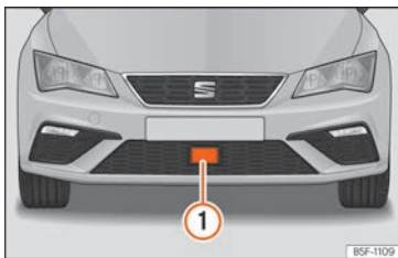
Rys. 271 Na przednim zderzaku: czujnik radarowy.
