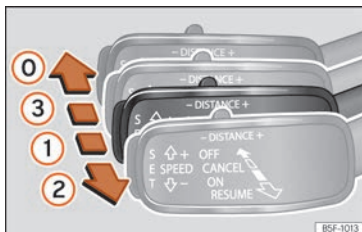
Rys. 272 Po lewej stronie kolumny kierownicy: trzecia dźwignia do obsługi tempomatu ACC.
