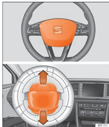
Rys. 26 Poduszka powietrzna kierowcy umieszczona w kierownicy.
