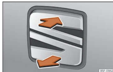
Rys. 8 Pokrywa bagażnika: otwieranie od zewnątrz.
