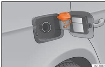
Rys. 61 Klapka wlewu paliwa z zaczepionym korkiem wlewu paliwa.
