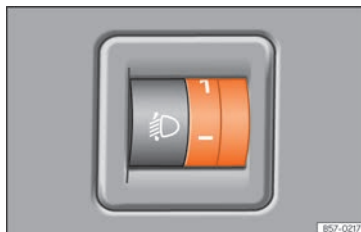
Rys. 153 Obok kolumny kierownicy: regulacja zasięgu reflektorów.
