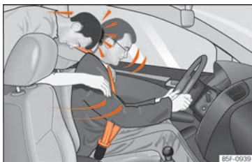
Rys. 95 Pasażer na tylnym siedzeniu nie posiadający zapiętych pasów bezpieczeństwa zostaje gwałtownie wyrzucony do przodu, uderzając kierowcę, który ma zapięty pas.
