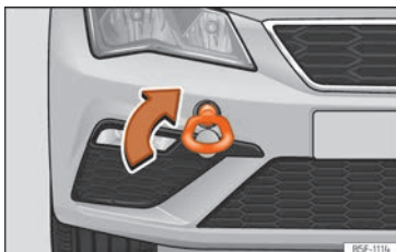
Rys. 101 Prawa strona przedniego zderzaka: wkręcony pierścień holowniczy.
