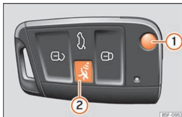
Rys. 141 Kluczyk samochodowy z przyciskiem alarmu.
