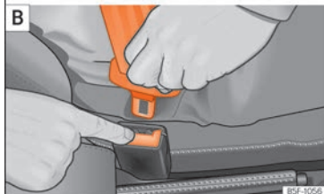
Rys. 21 Ułożenie pasa bezpieczeństwa i odpięcie klamry pasa.
