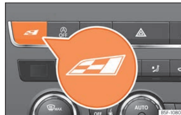
Rys. 282 Konsola środkowa: Klawisz profilu jazdy Cupra.
