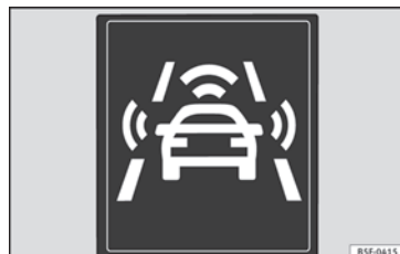
Rys. 214 Na tablicy rozdzielczej: komunikat wczesnego ostrzeżenia
