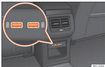
Rys. 237 Konsola środkowa, część tylna: złącza USB.
