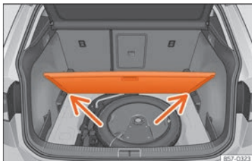
Rys. 181 Regulowana podłoga bagażnika: położenie pochylone.
