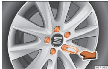
Rys. 75 Koło: śruby koła z nasadkami.
