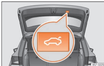
Rys. 145 Otwarta kłapa bagażnika: przycisk szybkiego zamykania kłapy.
