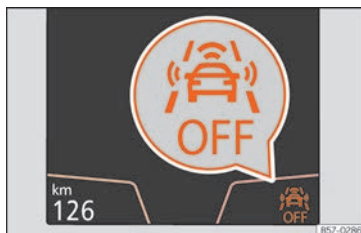
Rys. 256 Na ekranie tablicy przyrządów: komunikat o wyłączeniu systemu Front Assist.
