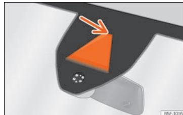
Rys. 266 Na przedniej szybie: pole widzenia kamery Asystenta pasa ruchu
