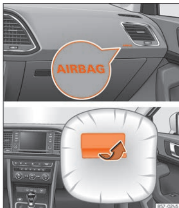
Rys. 27 Czołowa poduszka powietrzna pasażera umieszczona w desce rozdzielczej.
