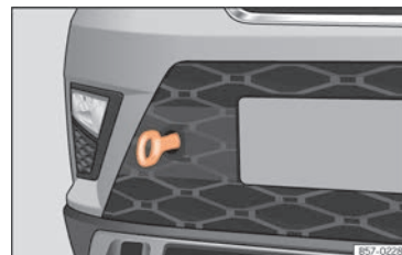
Rys. 80 Prawa strona przedniego zderzaka: wkręcony pierścień holowniczy.
