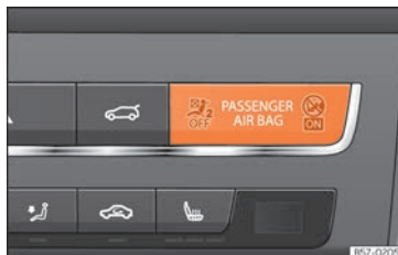
Rys. 99 Deska rozdzielcza: lampka kontrolna wyłączenia czołowej poduszki pasażera w konsoli środkowej.
