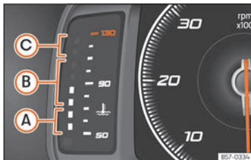
Rys. 131 Cyfrowa tablica przyrządów: wskaźnik temperatury płynu chłodzącego silnika.
