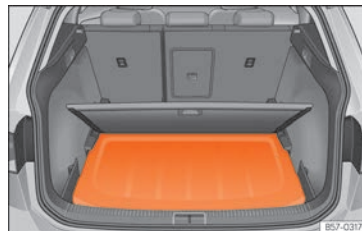
Rys. 173 W bagażniku: wkładanie tylnej półki.
