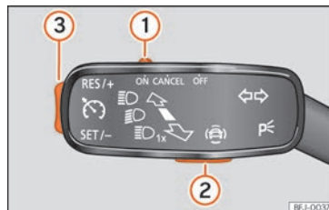
Rys. 54 Po lewej stronie kolumny kierownicy: przełącznik i przyciski do obsługi tempomatu.
