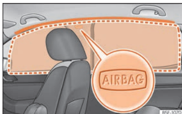
Rys. 34 Umieszczenie poduszek powietrznych chroniących głowę.
