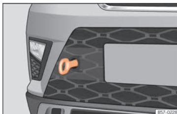
Rys. 102 Prawa strona przedniego zderzaka: wkręcić pierścień holowniczy.
