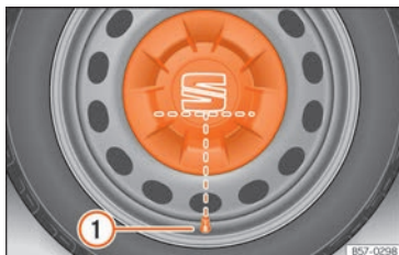
Rys. 74 Prawidłowo założona ostona piasty na feldze stalowej.
