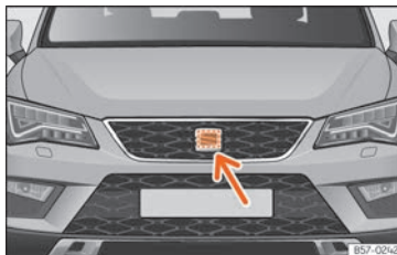
Rys. 255 Z przodu za znacznikiem SEAT-a: czujnik radarowy.
