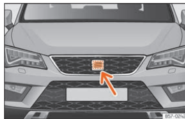
Rys. 260 Z przodu za znacznikiem SEAT-a: czujnik radarowy.
