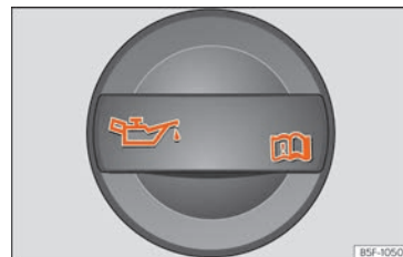
Rys. 63 W komorze silnika: Korek wlewu oleju silnikowego.
