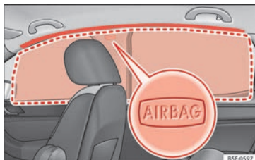
Rys. 25 Umiejscowienie i obszar wyzwalania poduszek chroniących głowę.
