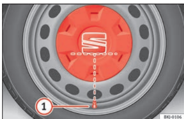
Rys. 76 Prawidłowo założona osłona piasty na feldze stalowej.
