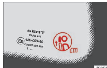
Rys. 95 Plakietka ostrzegawcza dot. położenia zagłówków.
