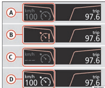
Rys. 183 Komunikat na tablicy rozdzielczej: Wskaźnik stanu tempomatu.
