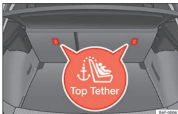
Rys. 31 Umieszczenie uchwyty Top Tether za tylnym siedzeniem.
