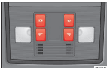
Rys. 40 Szczegółowy widok podsufity: oświetlenie przedniej części wnętrza.
