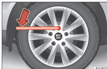
Rys. 80 Zmiana koła: poluzować śruby koła
