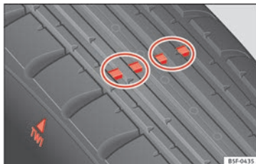
Rys. 239 Wskaźniki zużycia bieżnika opony
