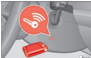
Rys. 175 Po prawej stronie kolumny kierownicy: rozruch awaryjny.
