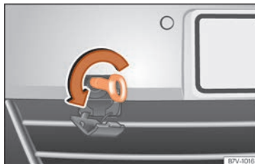
Rys. 105 Z prawej strony zderzaka przedniego: wkręcić pierścień holowniczy.
