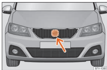
Rys. 263 Z przodu za znacznikiem SEAT-a: czujnik radarowy.
