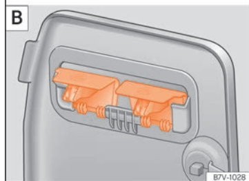
Rys. 169 Wyjąć wsporniki półki A, następnie odłożyć je w bezpieczne miejsce B.
