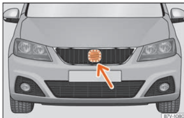
Rys. 259 Z przodu za znacznikiem SEAT-a: czujnik radarowy.
