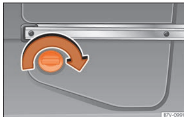
Rys. 288 Z lewej strony bagażnika: zbiornik AdBlue, za pokrywą.
