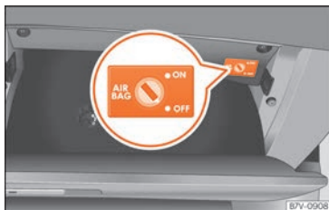
Rys. 29 W schowku podręcznym po stronie pasażera: przekaźnik czołowej poduszki powietrznej pasażera.
