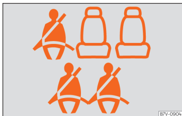
Rys. 85 Przykład wyświetlania stanu pasów bezpieczeństwa dla tylnych siedzeń (w samochodzie 7-miejscowym) na tablicy rozdzielczej: u góry drugi rząd foteli, u dołu trzeci rząd foteli.
