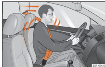
Rys. 86 Prawidłowo zapięty w pas kierowca nie zostanie rzucony do przodu w razie nagłego hamowania.
