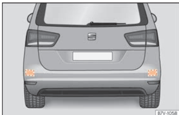
Rys. 272 Widok samochodu z tyłu: strefy działania czujników radarowych.
