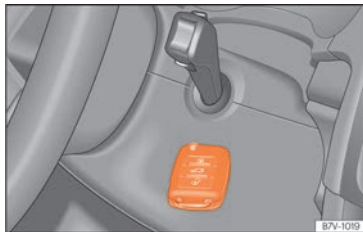
Rys. 238 Awaryjny rozruch silnika w samochodach z funkcją Keyless.
