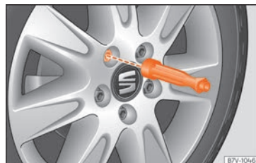
Rys. 73 Zmiana koła: poluzować śruby koła za pomocą końcówki klucza do kół
