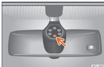
Rys. 149 Powierzchnia aktywna czujnika de- szczu
