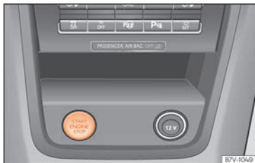
Rys. 237 Na środkowej konsoli: przycisk rozruchu w ramach funkcji Keyless. Układ w samochodach z kierownicą z prawej strony jest symetryczny.
