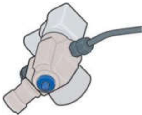
Ręczny zawór odcinający na zaworze głównym zbiornika
