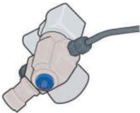
Ręczny zawór odcinający na zaworze głównym zbiornika
